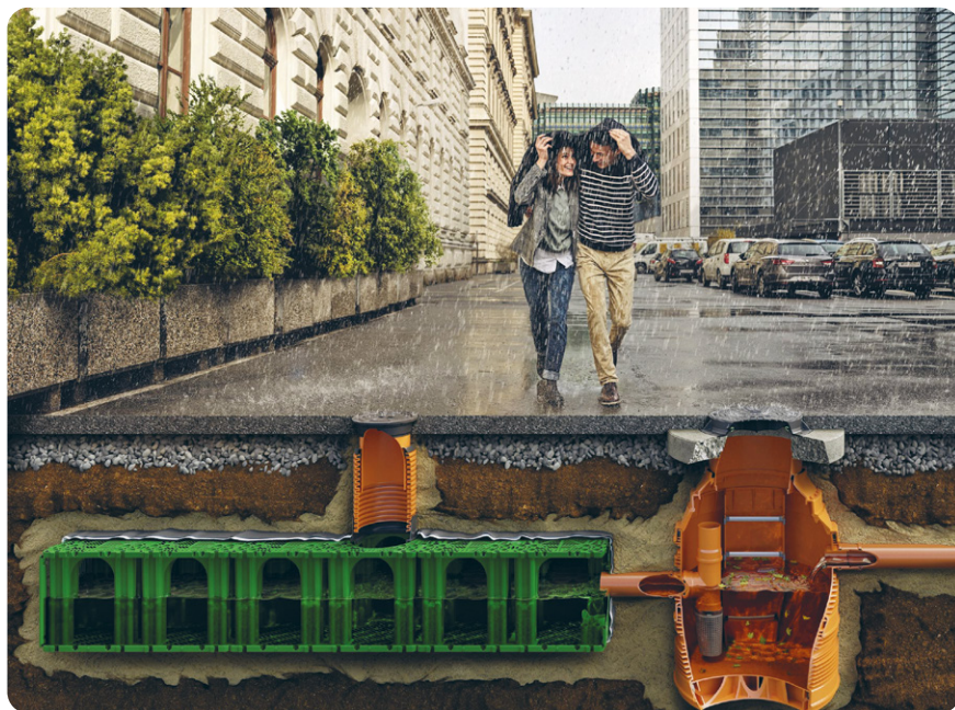
Foto 20. Vett mitteläbilaskva katendi all asuva imbkaevu läbilõige. Allikas: www.pipelife.com
