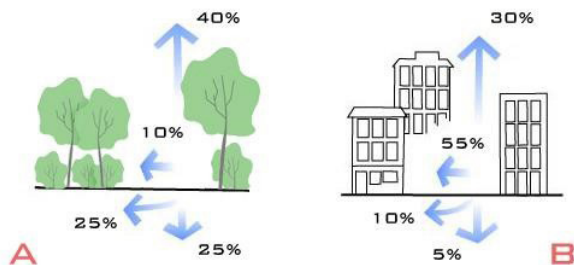
Joonis 2. Sademevee pinnasesse imbumise, aurumise ja üleujutusi põhjustava pindmise äravoolu üldistatud suhe looduslikus (A) ja linnastunud keskkonnas (B) protsentides (Dunnet & Clayden 2007 järgi).
