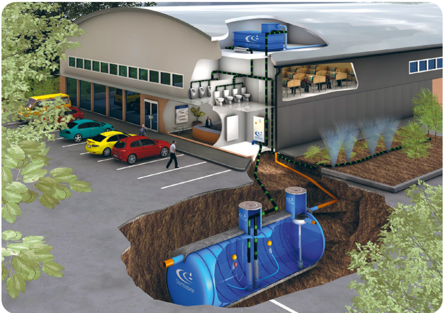
Foto 15. Sademevee kogumine mahutisse ning selle kasutamine majapidamises ja kastmisveena (Stormsaver Ltd, www.stormsaver.com ).
